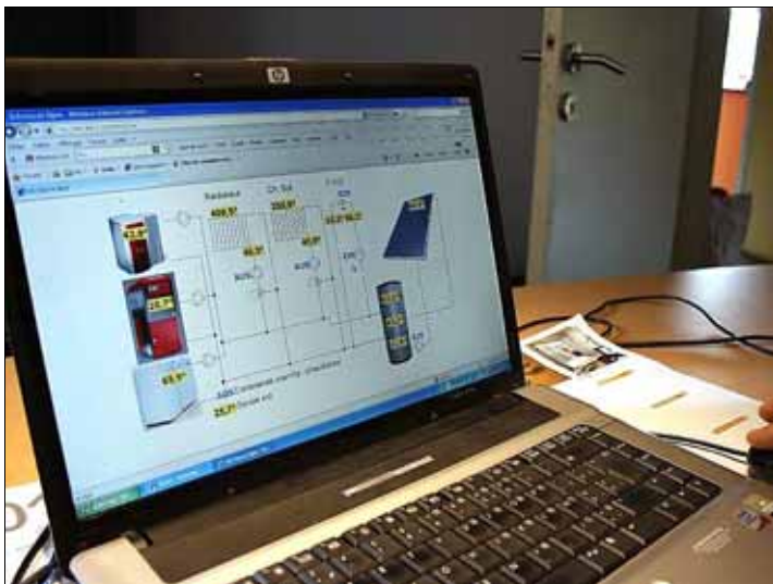
Geautomatiseerde supervisie van een verwarmingsinstallatie
